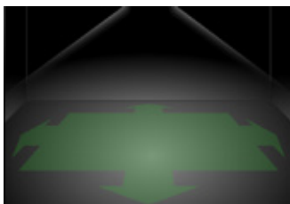
Flächenausleuchtung für 1 lux Symmetrisch 0°-0° Neigungswinkel
