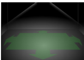
Fluchtwegausleuchtung für 1 lux Symmetrisch 75°-75° Neigungswinkel
